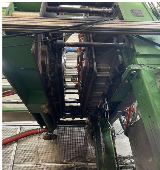
图 2 成型机的移模、合模装置
