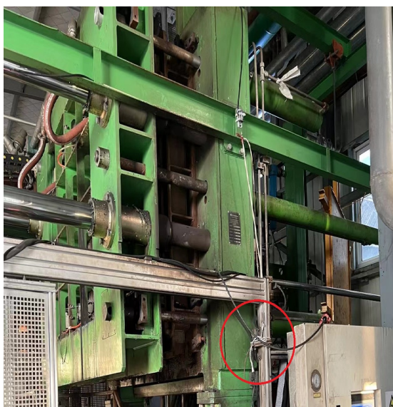
图 1 安全联锁行程开关被绳子绑扎
