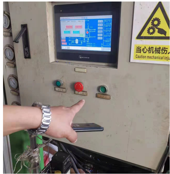
图 4 启动按钮处于内凹状态（第一现场）
